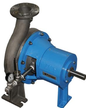
Entgasende, selbstansaugende Kreiselpumpe in Duplex Edelstahl mit integrierter Vakuumeinheit. Separiert Luft-, bzw. Gaseinschlüsse im Medium und verhindert so Kavitation. Flexibles Baukastensystem, sowie verschiedene Dichtungssysteme.
